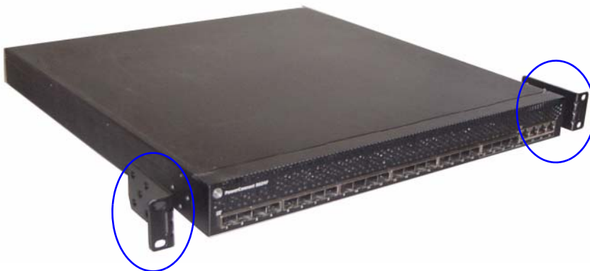
Ilustración 1. Fijación de los soportes
